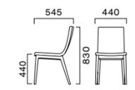
脚カット加工 最大カット寸法 20mm
