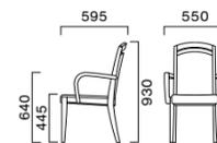
脚カット加工 最大カット寸法 45mm
